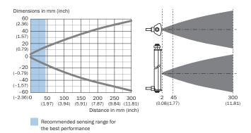
MULTITASK PHOTOELECTRIC SENSORS
